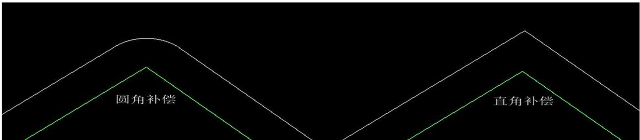
要取消补偿，请选择需要取消补偿的图形，然后单击“清除”按钮，选择“取消补偿”或直接选择割缝补偿对话框下的“取消补偿”按钮。
