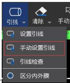
单击工具栏上的“手动设置引线”按钮，可以手工修改引入线。在图形上单击表示修改引入线的位置，但不修改角度和长度。同时可以添加引入和引出线，如图：
