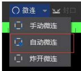
单击“微连”按钮右方小三角形下“自动微连”按钮，在弹出的对话框中设置参数，然后确定。可以选择按数量，例如每个图形加入 10 个微连，或者按距离，例如每隔 100mm 插入一个微连。
