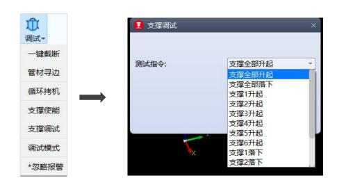
Y 下降位置参数大于当前实际 Y 坐标值的支撑被认为是安全支撑,可以在手动调试页面手动上升和下降。此时可以用秒表测量支撑上升和下降的时间,将支撑的上升/下降到位默认时间和下降位置参数做进一步调整。
