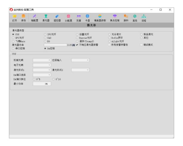
完成激光器配置后,可在软件右侧操作栏光闸栏处设置好激光点射的功率、频率等参数。设置好参数后, 打开光闸按激光键,查看激光器是否配置成功。
